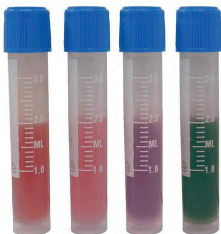
Risultati ottenuti con differenti stadi di deterioramento dell'olio. Da sinistra a destra: olio nuovo, buono, deteriorato, da cambiare
